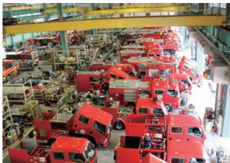
1台ごとに異なる仕様に応じて消防車が生産されている
