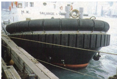
【船体取付式防舷材】世界トップシェア! あらゆる船の形に合わせるオーダーメイド。シバタ工業の独自技術あり!
