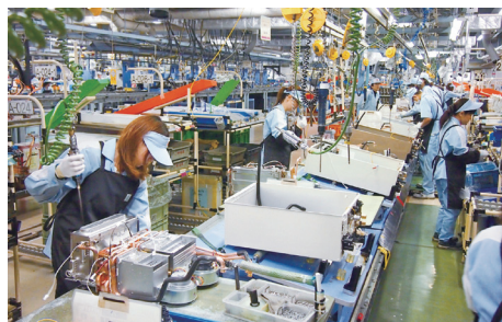
給湯器の生産ライン
